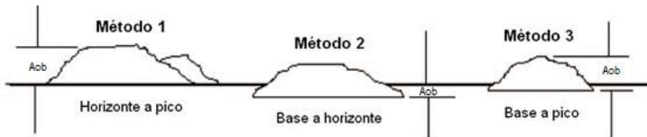
Figura 10: Métodos de Distancia a tierra con sextante.
